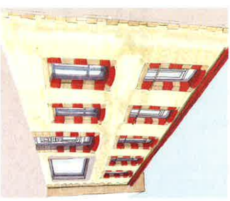
Remplacement de deux fenêtres par une baie vitrée
